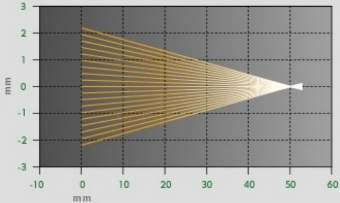
RAYS FROM A WAVEFRONT CODING IMAGING SYSTEM
